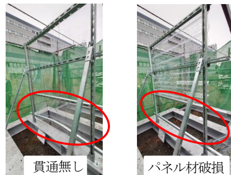
図-7 氷塊試験結果一例
