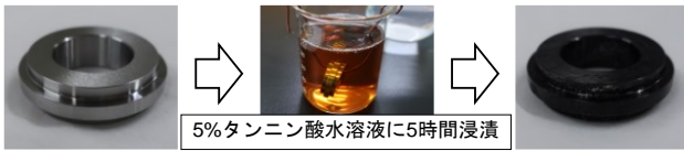
図3 レール輪表面の黒色皮膜の形成
