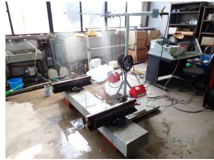
図-15 電気絶縁抵抗試験の状況
