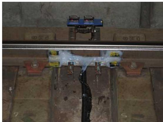
図-1 地上側PQ測定箇所
