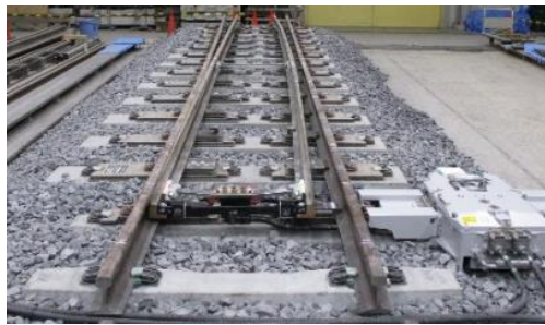
図-3 試作ポイント部による連続転換試験
