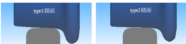
図-9 車輪踏面形状のモデル
