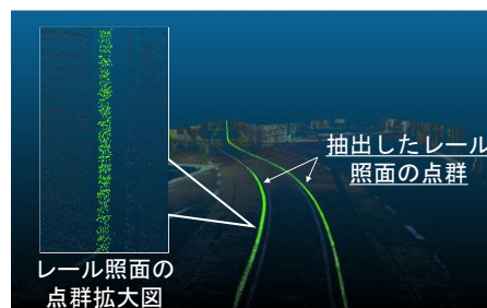
図-3 レール照面の抽出
