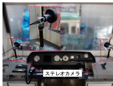
図-1 ステレオカメラ設置状況
