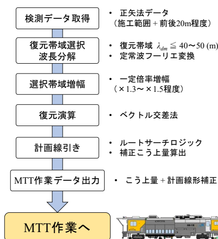
図-6 DL工法の概略
