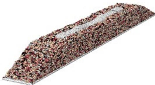
図-3 離散体バラスト軌道モデル (標準軌)
