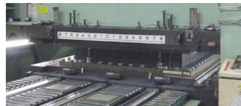
写真-1 鉛直荷重試験状況
