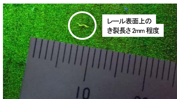
図-7 き裂確認結果の一例（No.2）
