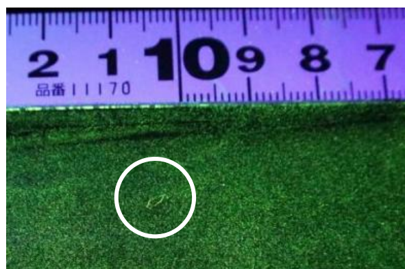
図-11 レール表面確認結果の一例
