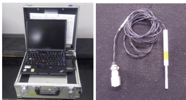
図-2 渦流探傷装置およびプローブ
