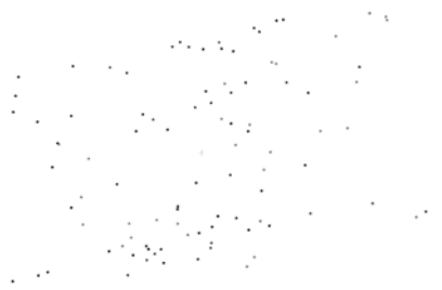
図-6 モデル点群（1点/25 cm²（5 cm四方に1点））
