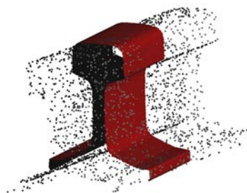
図-18(2) 位置合わせ結果 (×評価例：鉛直方向90° 回転)
