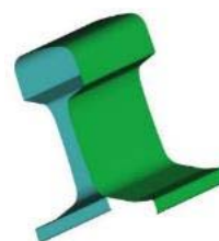
図-3 レールの3DCAD(長手方向100mm)
