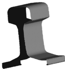
図-7 データ点群（1点/mm²（1 mm四方に1点））
