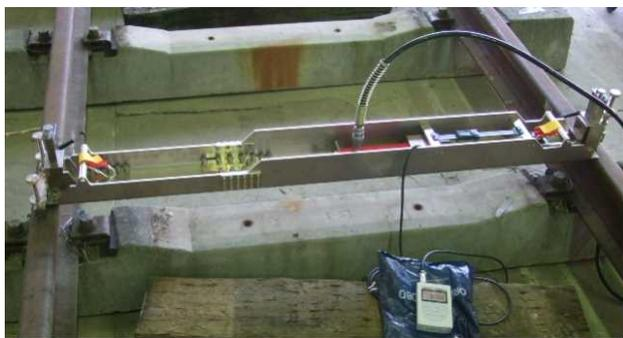
図-2 実験用軌道への横圧载荷治具の設置状況
