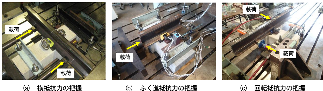
図-4 レール締結装置の抵抗力の測定状況（線ばね）
