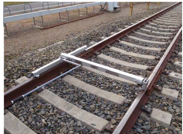
図-16 比較対象の高性能軌道検測器 (LR-S)
