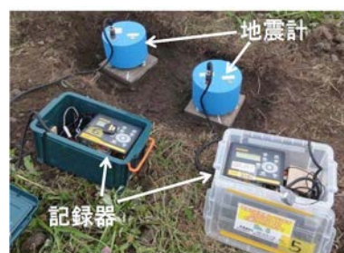
写真-1 観測機器の設置状況
