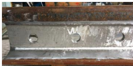
図-2 ケレン種別ごとの施工後の表面状態
