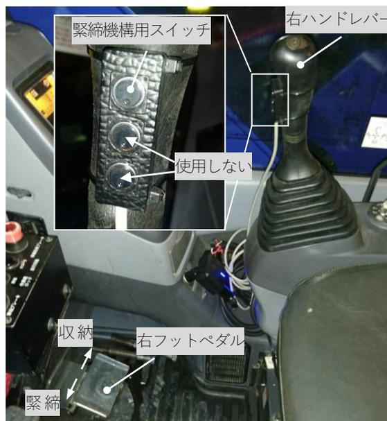
図 - 8 運転席の外観 (緊締機構操作スイッチ)
