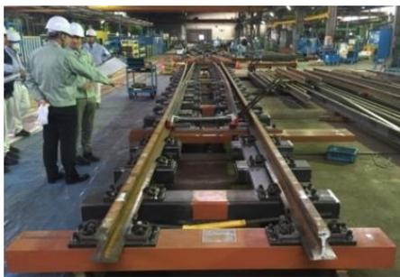
図-4 次世代分岐器ポイント部試作品
