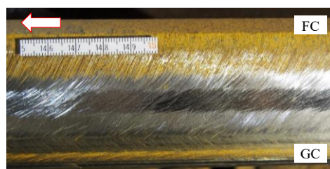
図-4 レール外観観察結果（15パス削正後）
