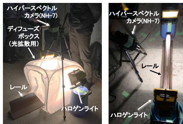
図-3 室内試験の作業風景
