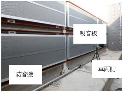
図-5 吸音板試験体の設置状況
