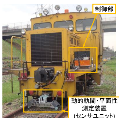
図-8 軌道用モーターによる試験状況
