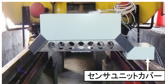
図-3 動的軌間・平面性測定装置（センサユニット）
