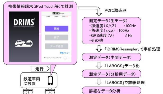
図-4 携帯情報端末による計測からデータ分析の手順
