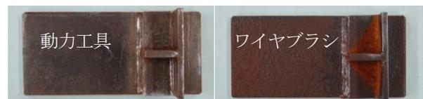
図-3 動力工具とワイヤブラシの素地調整状態
