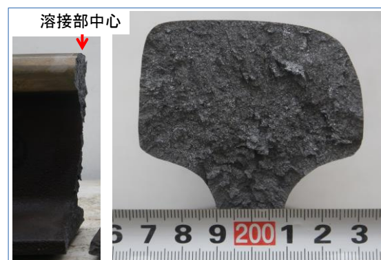
図-10 試験後の破断面の状況
