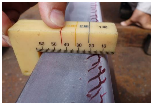
図-6 供試体に生じているきしみ割れの状況 (浸透探傷検査実施時)
