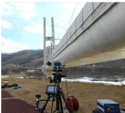
図-9 斜材の常時微動測定状況例
