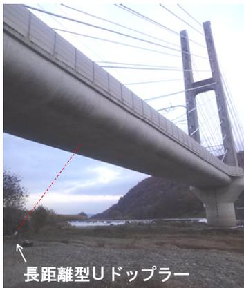
図-10 主桁の動的たわみ測定状況
