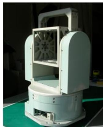
図-4 水平鉛直回転台
