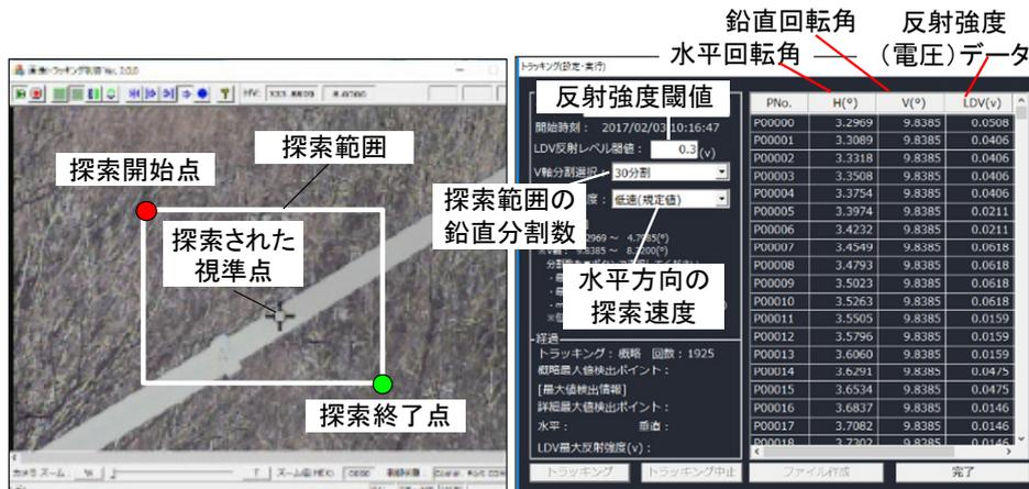
図-19 回転台制御プログラム画面と実斜張ケーブルの高反射輝度点探索結果
