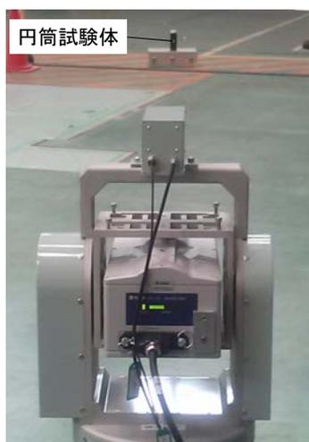
図-16 円筒試験体の高反射強度点探索実験
