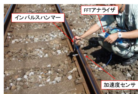
図-11 右側軸振動数の測定
