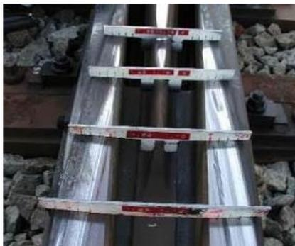
図-9 専用ゲージによる測定
