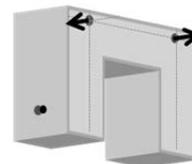
図-8 橋脚挙動概要図（鉛直軸周りのねじり）
