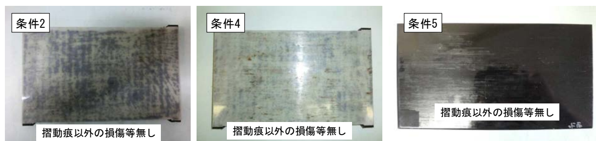
図-15 試験後の各摺動板の状況
