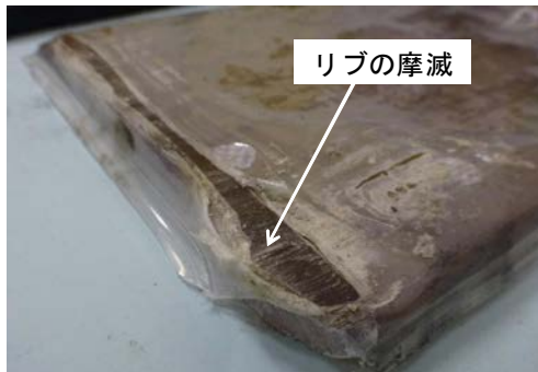
図-10 試験後の可変パッド (タイププレート面)
