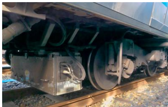
図-2 営業車両に搭載された慣性正矢軌道検測装置の例
