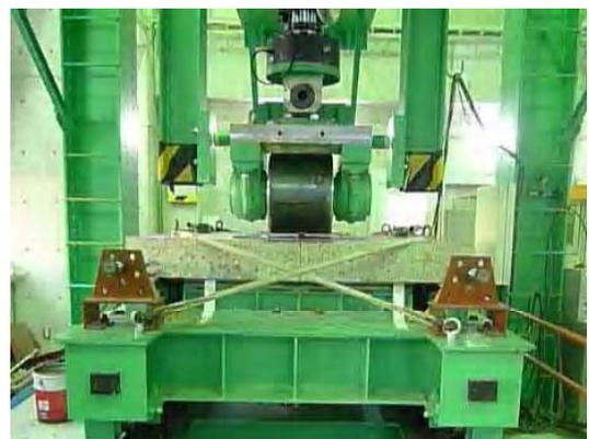
写真－2 輪荷重走行疲労実験状況
