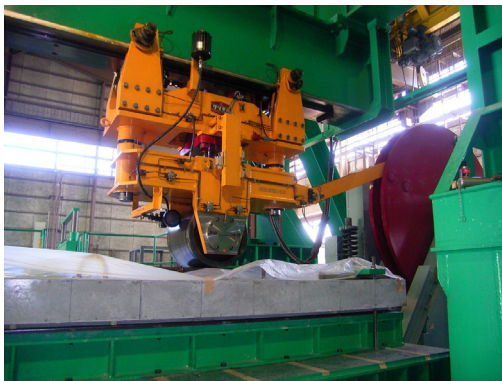
写真-5 輪荷重走行試験機(クランク式)
