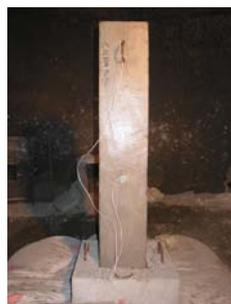
(a) C4 爆薬 (b) C4 爆薬を装てんした試験体
