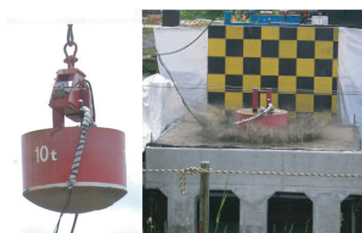
写真－３ 重錘（10,000 kg）と衝突状況写真
