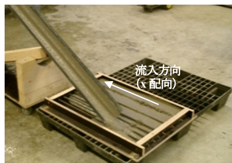
x 配向（鉄筋の方向）の打設方法
