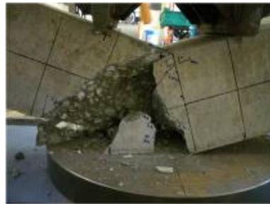
写真-1 継手破壊の状況
