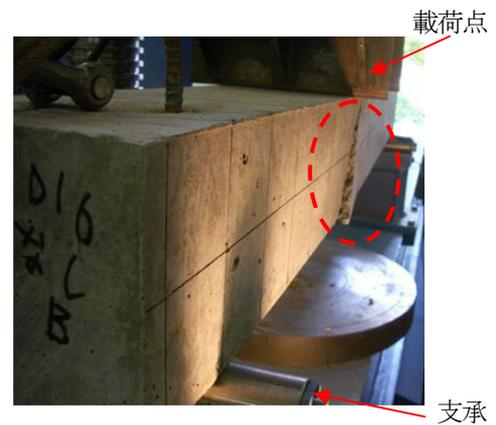
写真-5 コンクリートのはらみ出しの様子
