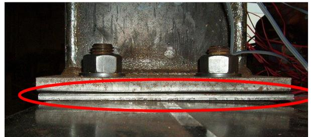
図-15 鋼箱の底板に溶接されたスペーサー
