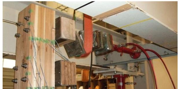
図-14 水平載荷試験機の設置
