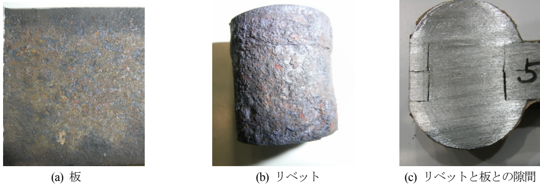
図-6 リベット継手の腐食状態
