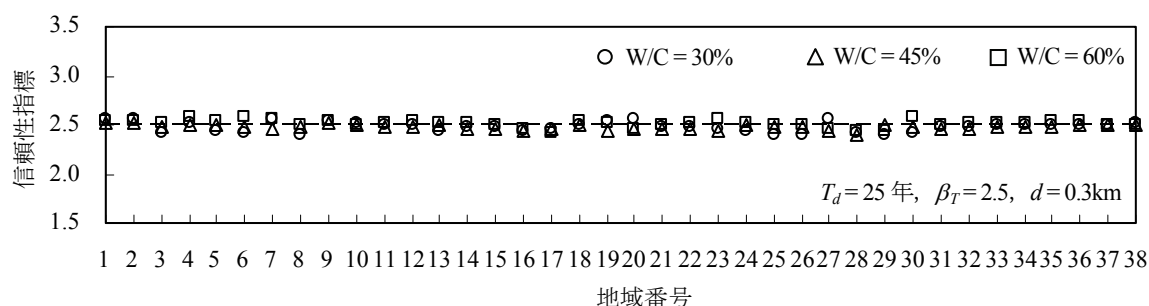
c) 設計時に許容する鉄筋腐食量：質量減少率 5%点 ( \phi=0.23 )
