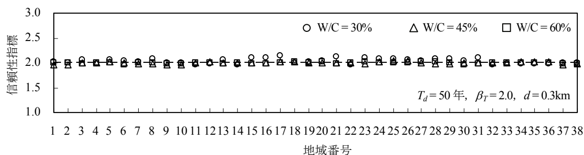
d) 設計時に許容する鉄筋腐食量：質量減少率 20%点 ( \phi=0.49 )
