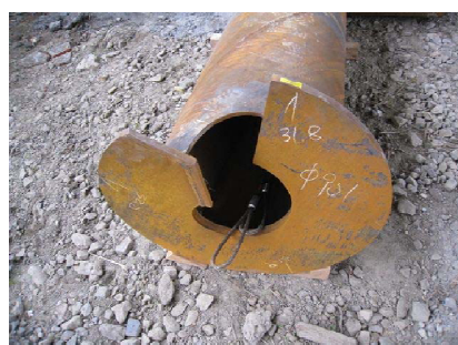
写真-1 回転圧入鋼管杭
