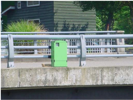
写真-2 土研式塩分捕集器具の設置例
