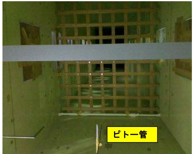
図-3 風洞内の格子設置状況
