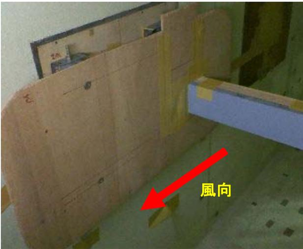
図-5 端板の設置状況
