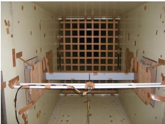
図－9 後流の変動風速計測
