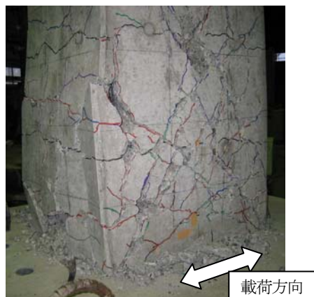
写真-6 載荷ステップ 6 \delta y の状況 (供試体 No. 6)
