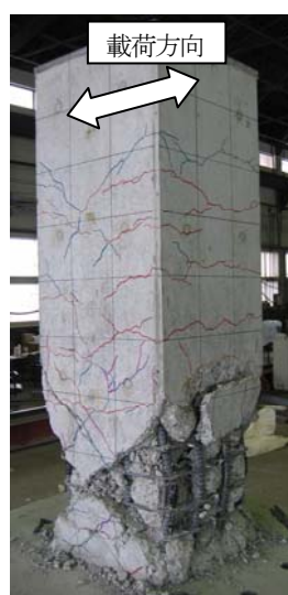
写真-4(a) 実験終了後の供試体 (供試体 No. 1)
