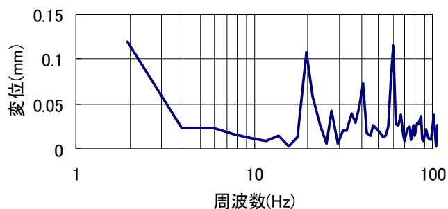
図-22 b=4500\text{mm} の場合のスペクトル解析結果
