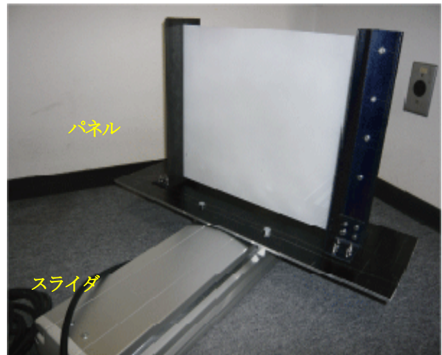
図-2 実験模型と加振装置 (スライダ)
