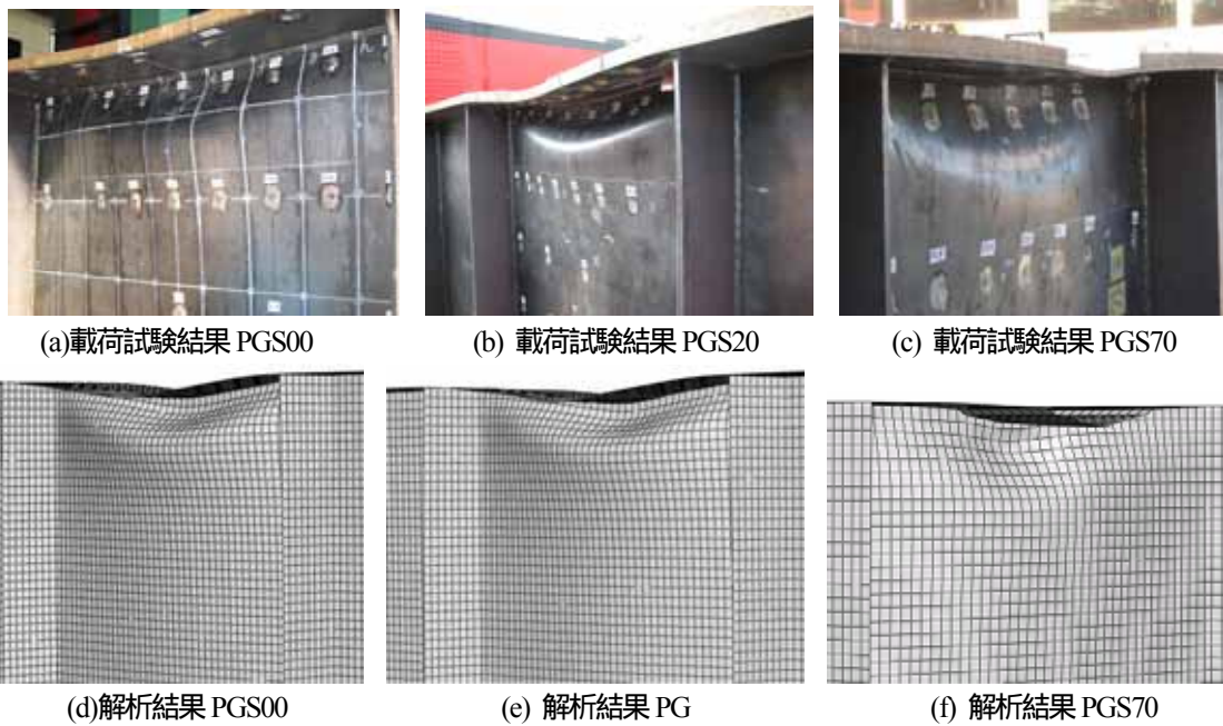
図-20 終局時の桁の変形（載荷試験結果と解析結果の比較）
