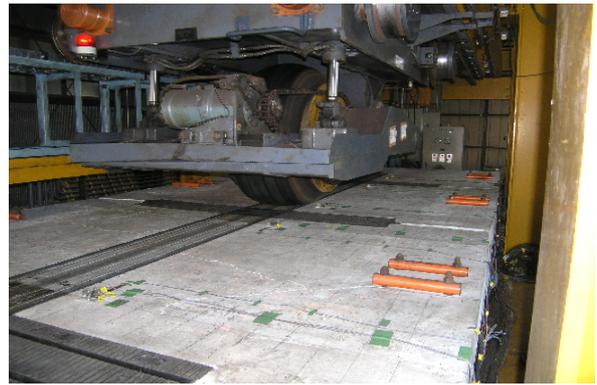
写真-1 輪荷重走行試験状況
