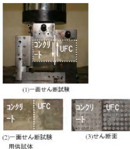
図 - 7 モード Ⅰ 型一面せん断試験装置およびせん断面
