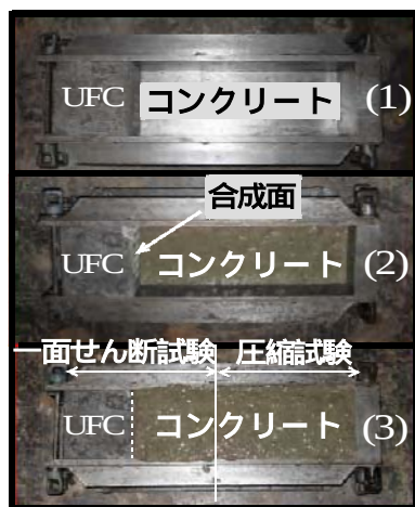
図 - 6 一面せん断試験用供試体の製作方法
