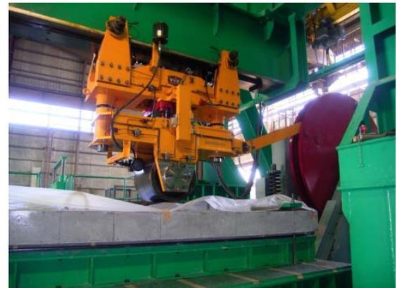
写真 - 7 輪荷重走行試験機 (クランク式)
